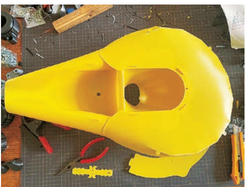
テンダーさん設計のドライトイレ「コヤッシー」。ポリプロピレンシートを切り抜き、手で折って組み立てる。
